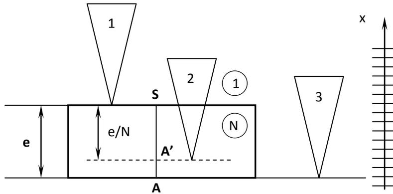
Le deuxième pointé revient à effectuer la mise au point du microscope sur l'image du second dioptre de la lame par rapport au premier.
