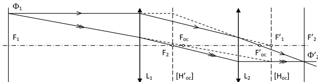
On constate que  $H_{oc}$  est en  $F'_1$  et  $H'_{oc}$  en  $F_2$ .
