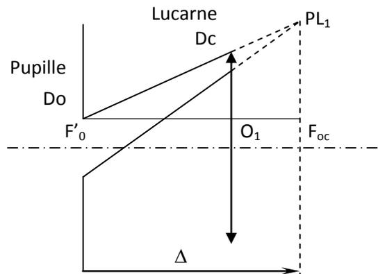
Le faisceau utile, à la limite du champ de pleine lumière dans l'espace image de l'objectif, a pour sommet  $PL_1$  sur  $[F_{oc}]$  ; il s'appuie sur la pupille et tangente intérieurement la lucarne.
